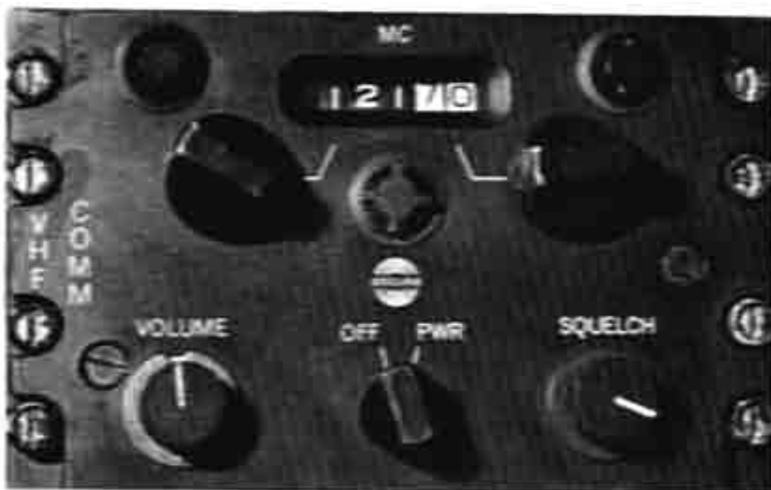
Fig. 1-37 VHF(AM) Radio, Collins 618F-1A
