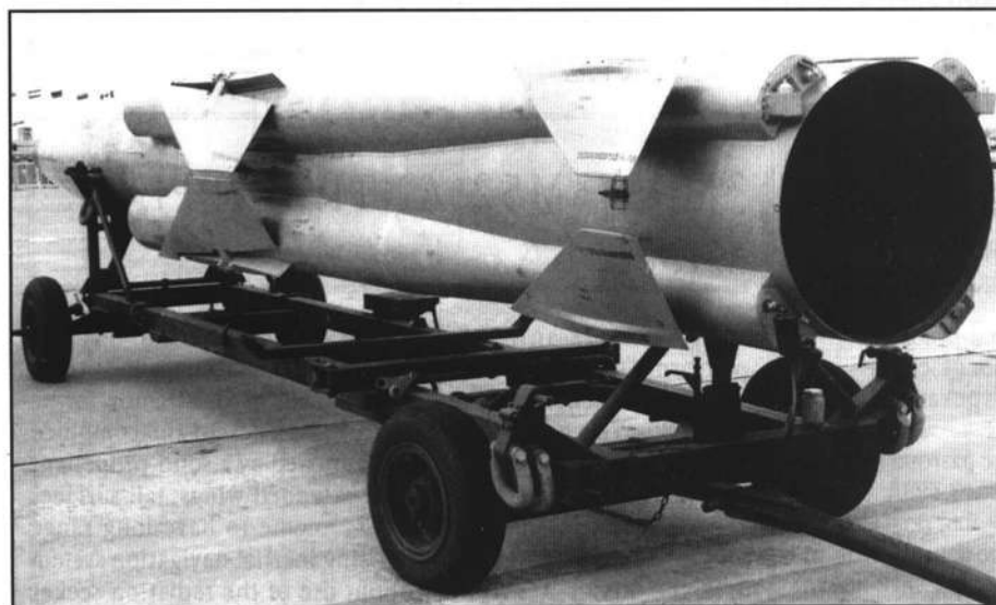
◀ Противокорабельная ракета X-41 «Москит». Фото С. Попсуевича X-41 «Moskit» anti-shiping missile. (S. Popsuevich)
