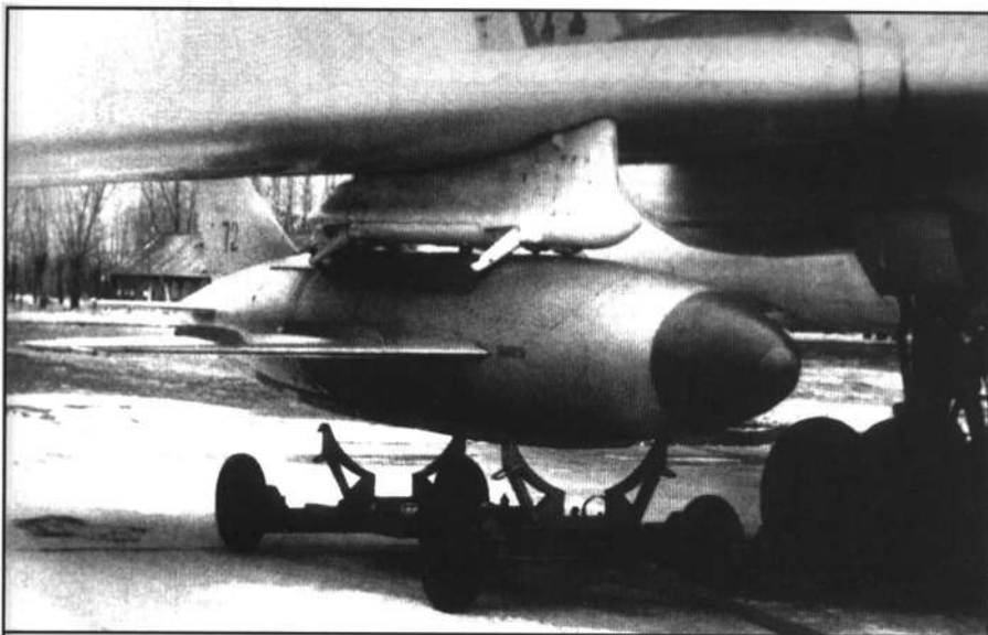
▲ Египетский Ту-16 с двумя ракетами КСР-2. Из архива редакции Egyptian Tu-16 carries two KSR-2 cruise missiles. (Editorial archives)
