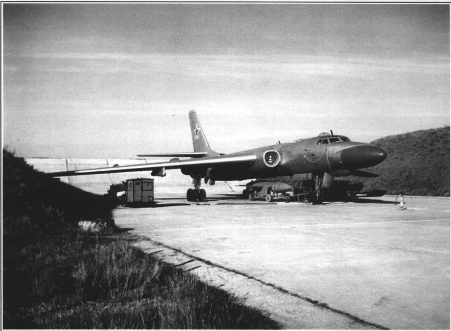
Морской ракетносец Ту-16К-10-26. Под фюзеляжем самолета - противокорабельная ракета К-10, под левой консолью крыла - учебная ракета КСР-5. Фото из коллекции авторов Tu-16K-10-26 missile carrier. The K-10 anti-ship missile is beneath the fuselage and the KSR-5 training aid under the port main panel. (The photo from the author's collection)
