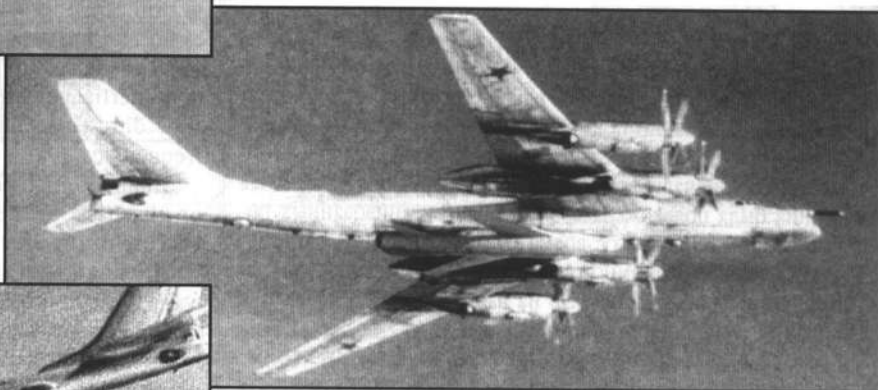
▲ X-20M под фюзеляжем Ту-95KM. Из архива редакции X-20M beneath Tu-95KM fuselage. (Editorial archives)
