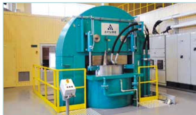
Hot Isostatic Press QIH 0,9 x 1,5-2070-1400 MURC (Quintus Technologies AB, Sweden)
