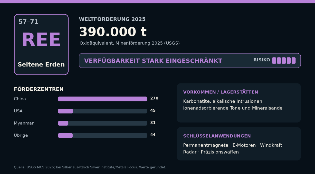
Abb. 10: Seltene Erden: Förderung 2025, Hauptländer, Lagerstätten und Magnetanwendungen.
