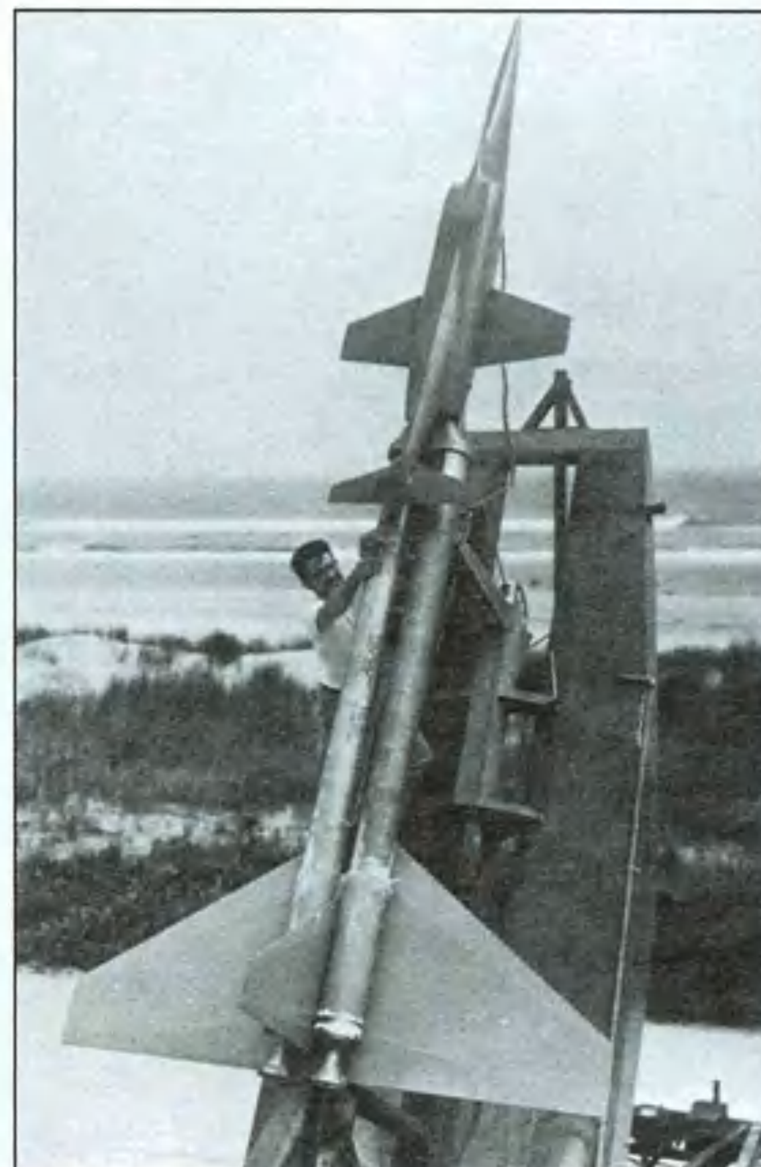
Les techniciens de la division de recherches d'engins non pilotés du NACA préparent le lancement de la maquette finale du X-3 à partir de Wallops Island (Virginie). Le modèle réduit atteignit Mach 1,43 le 13 juin 1952.
