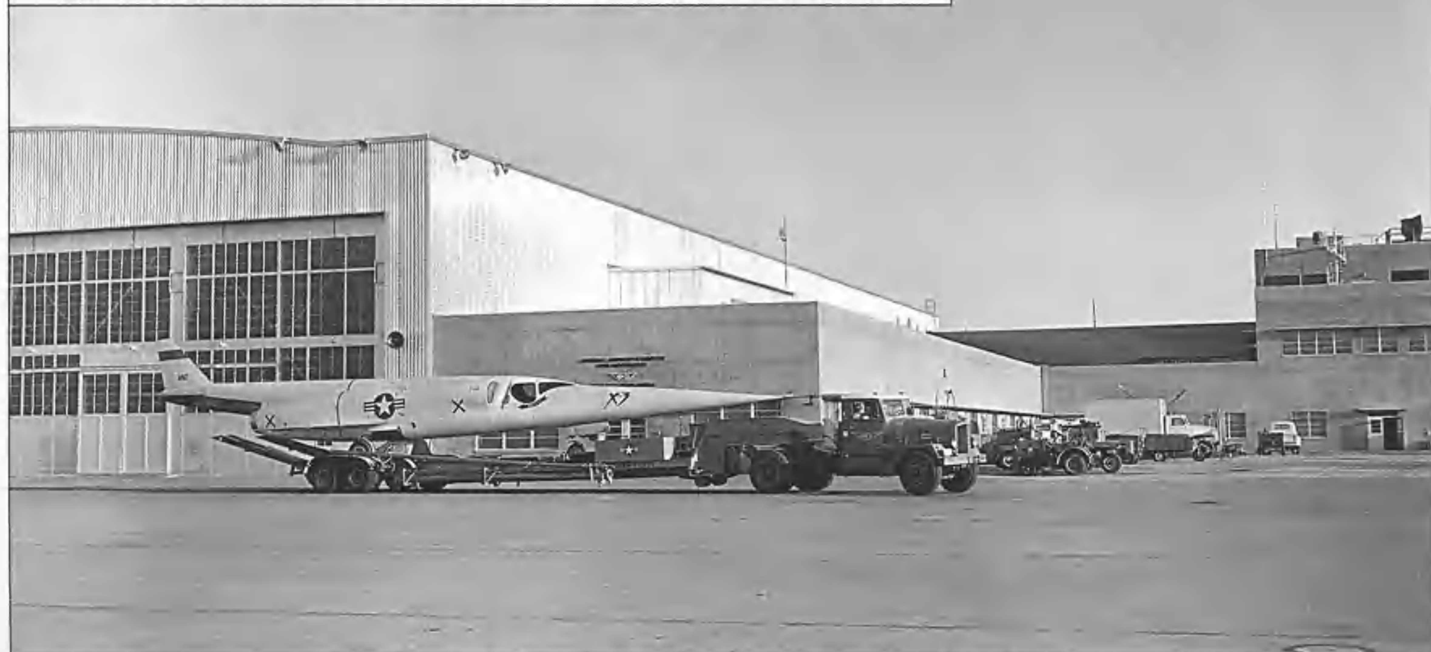
Le X-3 remorqué derrière le hangar du NACA à la base d'Edwards vers le lac asséché Rogers (1956). Les pneus étaient minuscules sur cette machine et afin de les protéger de l'usure et des déchirures, l'avion était transporté vers le lac Rogers sur une remorque.
