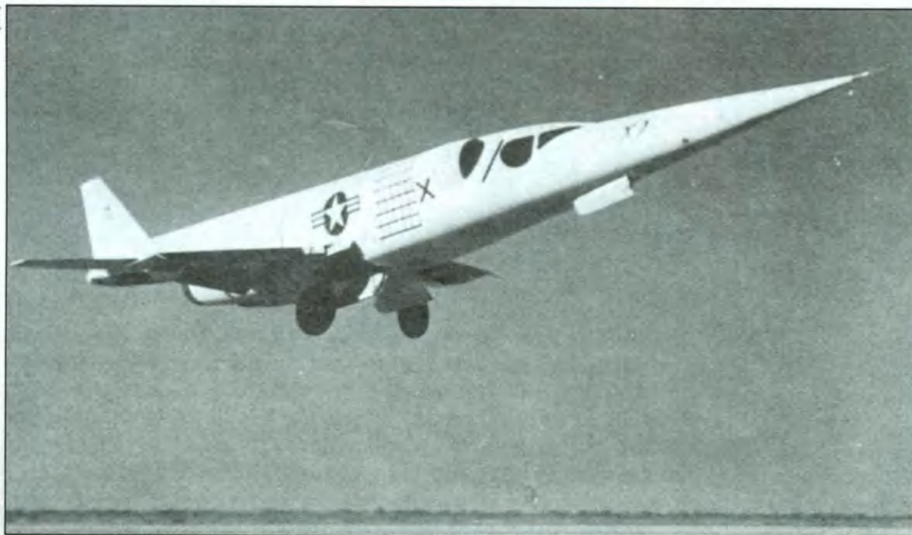
Le X-3 au décollage du Rogers Dry Lake pendant la phase I du programme X-3 en 1953. Le train avant vient juste d'être relevé. Les phases de décollage et d'approche retinrent particulièrement l'attention du NACA.
