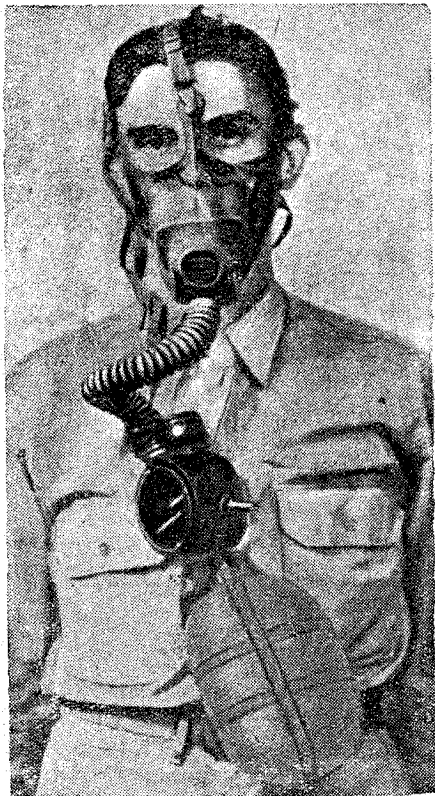
Рис. 11. Переносный кислородный прибор А-13
